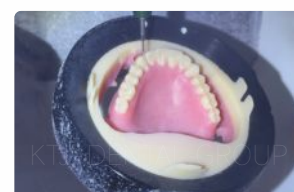
义获嘉Ivotion树脂盘 切削完成义齿制作
